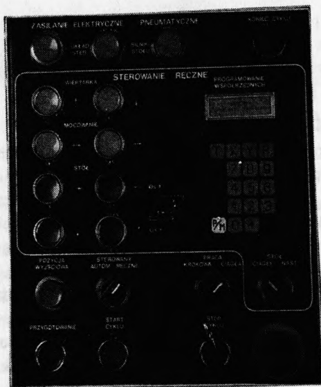
Rys. 12. Zautomatyzowana wiertarka współrzędnościowa sterowana programowo. a) odmiana wiertarki z pneumatyczną jednostką obróbczą, b) odmiana wiertarki z elektro-pneumatycznym zespołem obróbczym, c) pulpit sterujący wiertarki.
