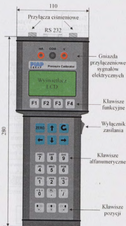
Rys. 5.5. Widok płyty czołowej kalibratora ciśnienia PC-02
