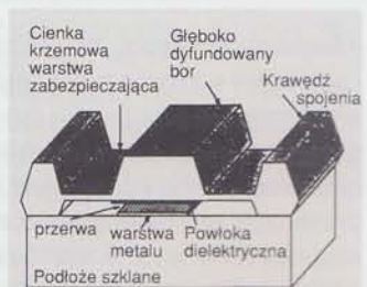
Rys. 14. Przekrój poprzeczny czujnika
