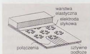
Rys. 8. Schemat budowy sensora taktylnego z czujnikiem temperatury
