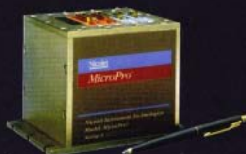
Fot. 11. Rejestrator typu Micro-Pro (Nicolet) do badań katastroficznych
