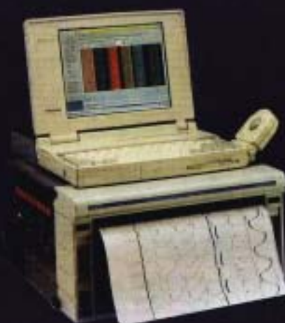
Fot. 10. System rejestrujący typu Cobra 16 (Gould) oparty o notebook i termiczny wielokanałowy zestaw rysujący. System dokonuje w czasie rzeczywistym poza rejestracją również przetwarzania matematycznego i rysowania wyników tych przetworzeń wraz z sygnałami wejściowymi.
