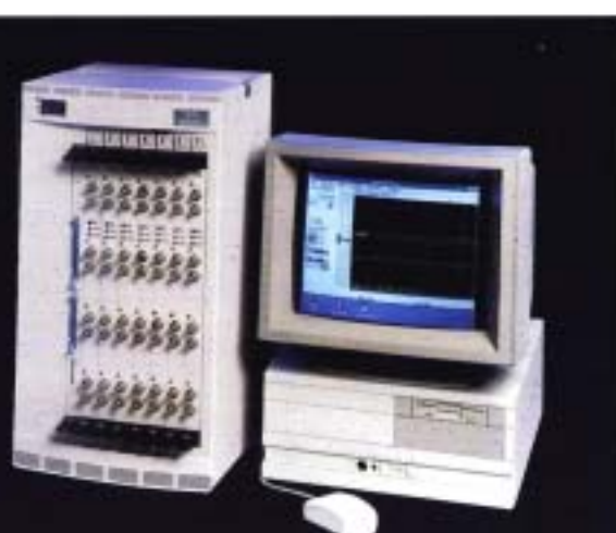
Fot. 9. Rejestrator typu Multi-Pro (Nicolet) do zapisu w pamięciach półprzewodnikowych szybkich przebiegów jednorazowych. Każdy moduł wejściowy zawiera autonomiczny zespół rejestrujący
