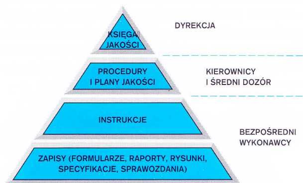
Rys. 1. Struktura dokumentacji systemu jakości
