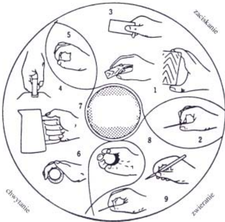
Rys. 2. Rodzaje chwytania: zaciskanie (1, 2, 3 i 5), zwieranie (2, 8 i 9), chwytanie (4, 5, 6, 7 i 8)
