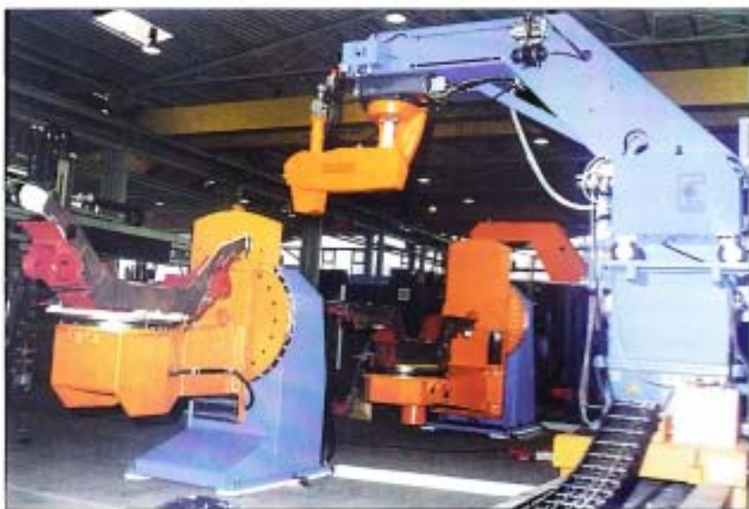
Zrobotyzowane stanowisko do spawania podzespołów maszyn budowlanych. Robot spawalniczy ROMAT 310 przemieszczany jest za pomocą obrotowego stenda, umieszczonego dodatkowo na jezdni typu LVE. Do manipulacji elementami przeznaczonymi do spawania służą dwa pozycjonery typu „L”.
