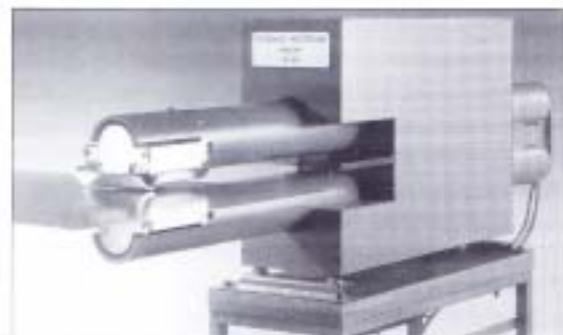
EMICRON – urządzenie elektromagnetyczne do pomiaru grubości
