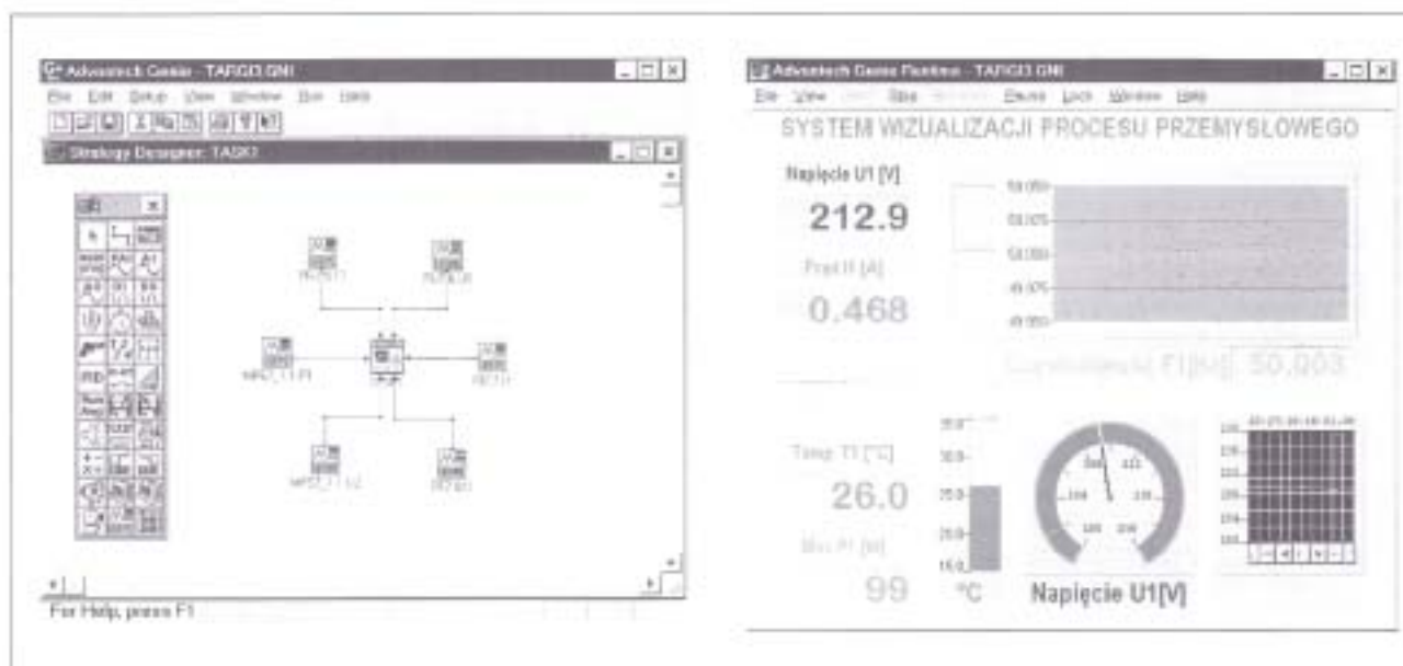
Przykład ekranu z programem GENIE przy monitorowaniu wielkości energetycznych
