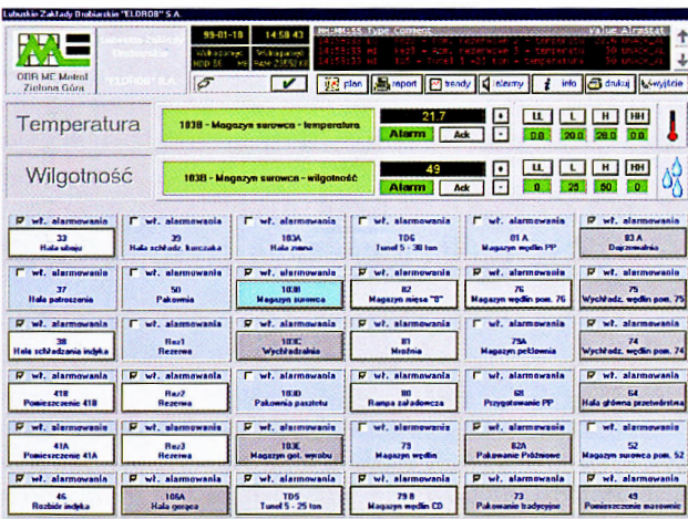
Rys. 6. Okno definiowania zakresów alarmowych
