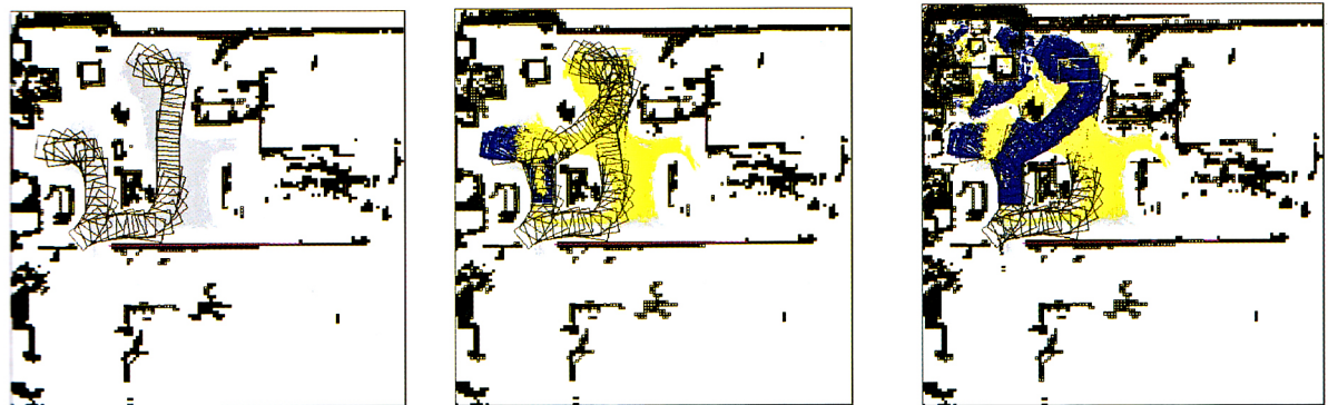
Rys. 6. Przejazd z wykryciem otwartego przejścia
