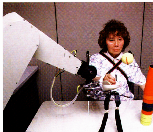
Rys. 3. Robot PUMA 560 wyposażony w interfejs do rehabilitacji neurologicznej [4]
