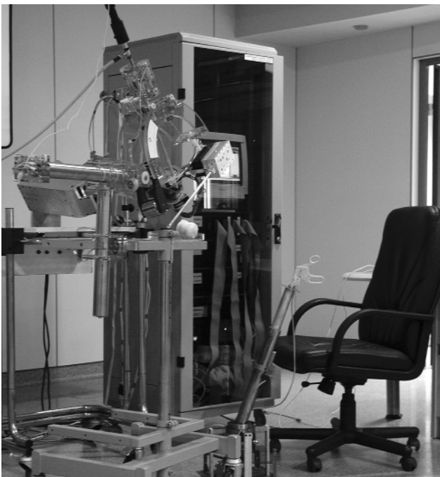
Fot. 1. Rozwiązanie złożone z przedprototypu ramienia robota RobIn Heart oraz kamery endowizyjnej umieszczonej w sferycznym modelu ramienia – przedstawione na Konferencji RoMoCo 2002 [2]
