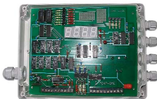
Rys. 5. Układ pomiaru czasu reakcji skanera
