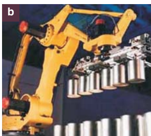
Rys. 3. Chwytniki grupowe realizowane przez roboty firmy Fanuc [3]: a) świetlóówki uchwycone przysawkami, b) metalowe elementy cylindryczne uchwycone elektromagnesami
