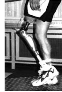
Rys. 1. Widok nóg człowieka poruszającego się za pomocą protezy hydraulicznej wyposażonej w system sterowania mikroprocesorowego C-LEG (Zapfe Orthopädie-Technik)
