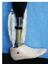
Rys. 7. Widok protezy kończyny dolnej ze sztucznymi mięśniami pneumatycznymi McKibben [7]
