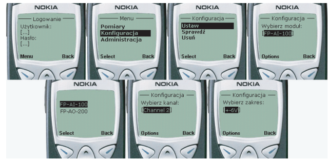
Rys. 3. Konfiguracja zakresu pomiarowego poprzez stronę WAP
