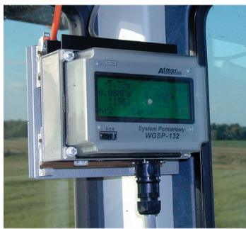
Rys. 3. Zamontowany w kabinie operatora rejestrator parametrów wytwarzanych paliw betonowych
