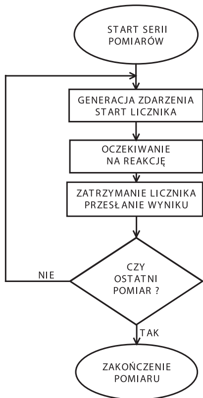
Rys. 5. Graf działań programu realizującego pomiar opóźnienia
