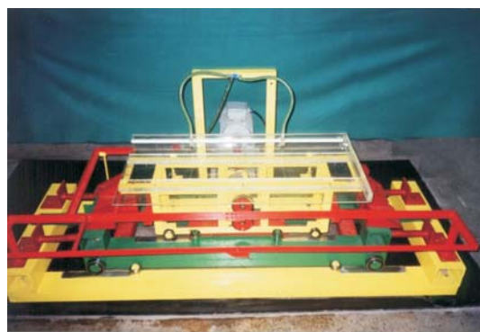
Rys. 2. Stół koncentracyjny z napędem bezwładnościowo-udarowym. Schemat kinematyczny i model fizyczny
