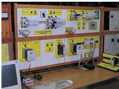
Rys. 1. Stanowiska laboratoryjne: rozruch i regulacja prędkości silnika indukcyjnego
