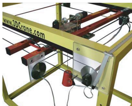
Rys. 2. Suwnica laboratoryjna, model edukacyjny (b)
