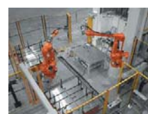
Rys. 8. Roboty przemysłowe firmy ABB: a) typ IRB 6400R, b) stanowisko obsługi prasy
