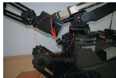
Rys. 3. Uszkodzenie przedniej kamery oraz elementów nadgarstka spowodowane złą koordynacją ruchu ramion
