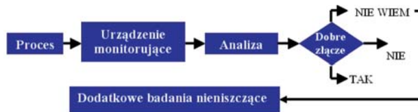
Rys. 2. System monitorowania procesów spawania
