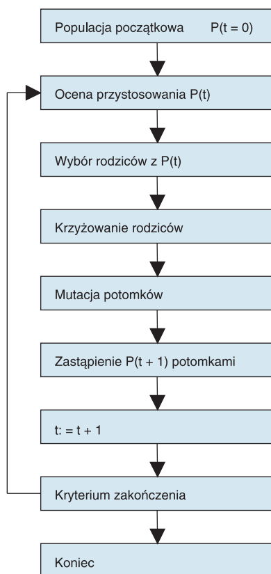
Rys. 3. Schemat działania algorytmu genetycznego
