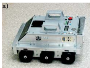
Rys. 1. Platforma mobilna robota Elektron: a) widok ogólny, b) podstawowe wymiary (mm)
