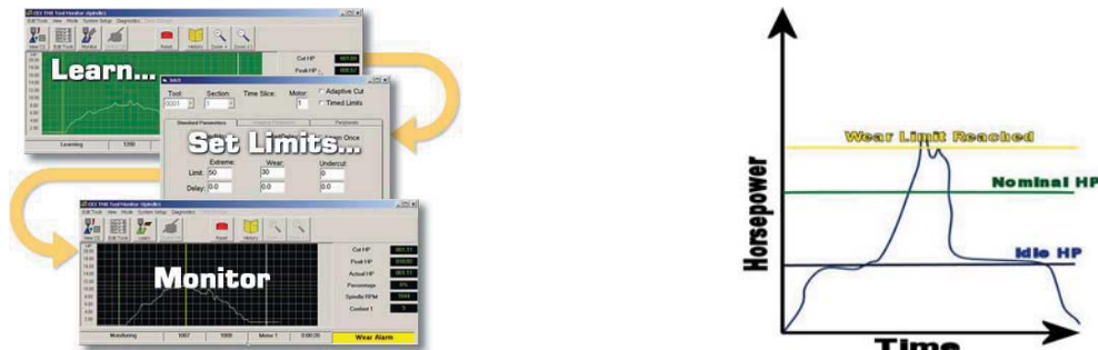
Rys. 5. Monitorowanie mocy na wrzecionie [8]
