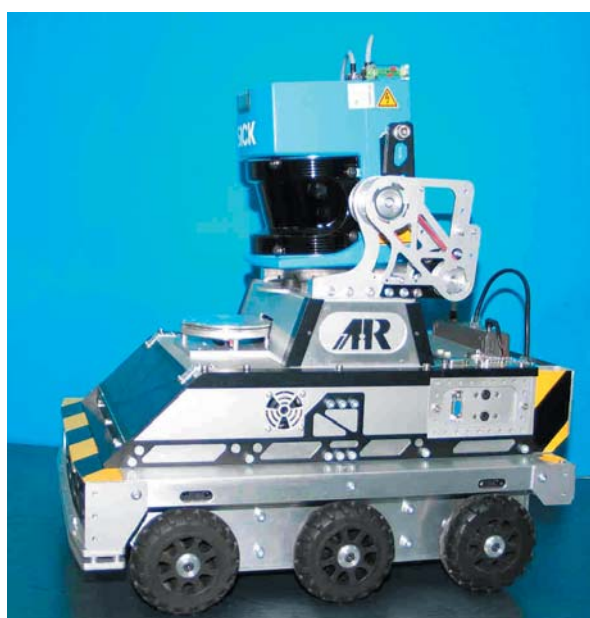
Rys. 1. Robot ELEKTRON wyposażony w skaner laserowy
