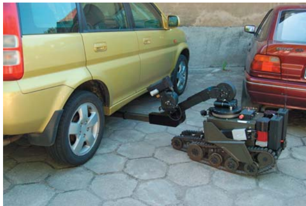
Rys. 7. Robot Expert podejmuje ładunek spod podwozia samochodu
