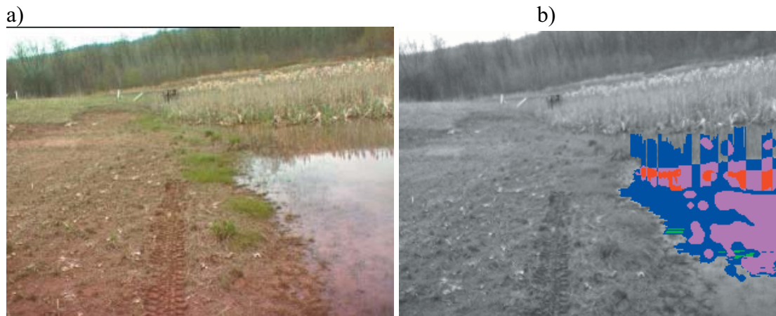
Rys. 8. Zbiornik wodny znajdujący się obok trasy pojazdu: a – obraz terenu; b – wyznaczenie powierzchni wody
