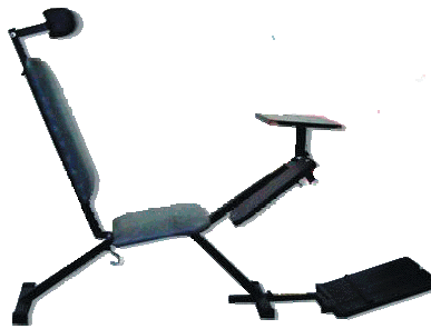
Rys. 4. Widok ogólny fotela pilota w symulatorze
