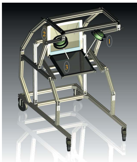
Rys. 7. Model komputerowy CAD (a) oraz rzeczywisty widok w czasie pracy laboratoryjnej (b) konsoli sterowniczej Robin Heart Shell ®
