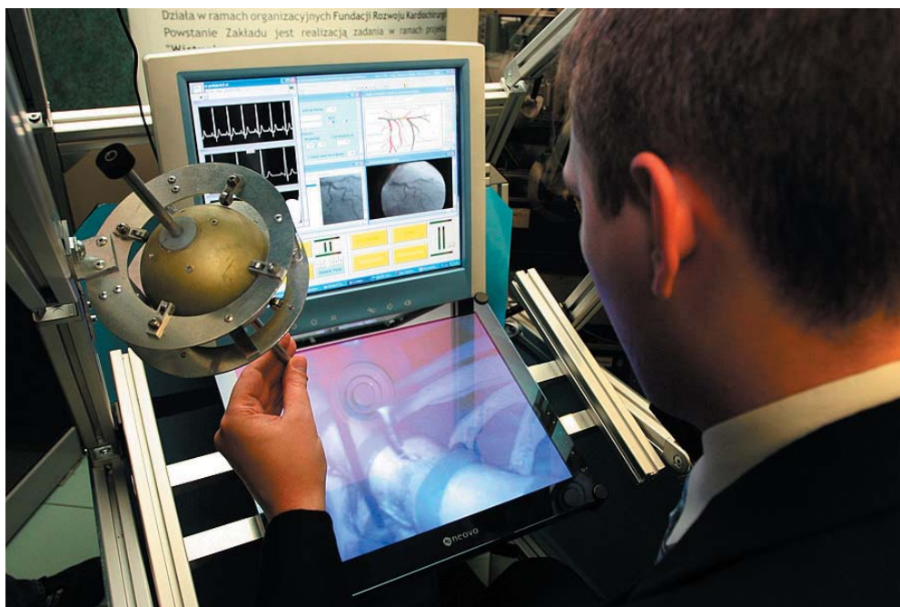
Rys. 8. Konsola sterownicza: zadajnik Master robota narzędziowego (po lewej), monitor pola operacyjnego (poniżej), monitor techniczny (powyżej) konfigurowany wg życzenia operatora
