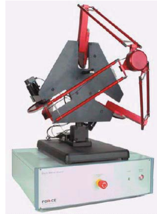
Rys. 3. Urządzenia dotykowe produkowane przez firmę Force Dimension: a) 3-DOF OMEGA, b) 3-DOF DELTA [8]
