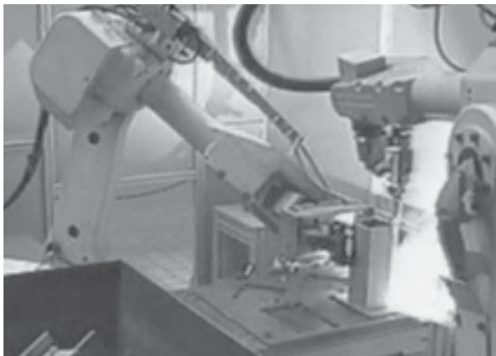
Fot. 3. Stanowisko spawania elementów pras
