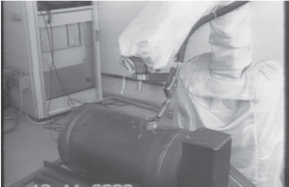
Fot. 2. Zrobotyzowane stanowisko spawania głowicy zaworu zbiornika gazowego
