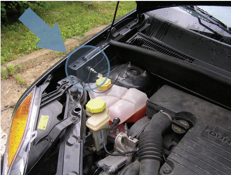
Rys. 9.4. Położenie czujnika drgań pełniącego funkcję źródła odniesienia w komorze silnika Forda Fusion
