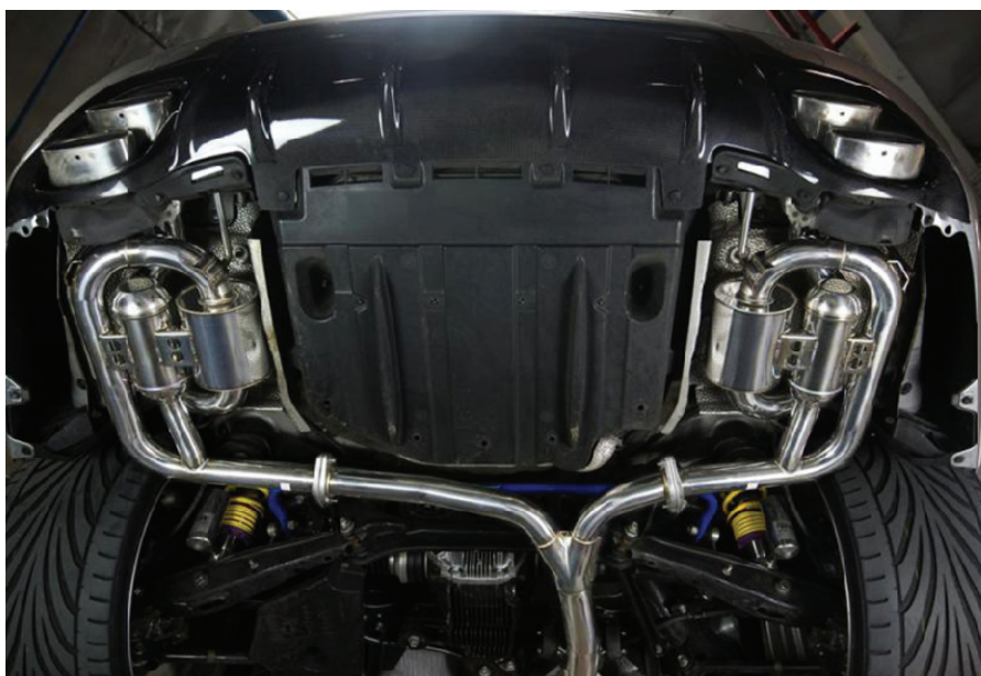
Rys. 2.10. Układ wylotowy z tłumikami przelotowymi silnika turbodoładowanego RB25DET [98]
