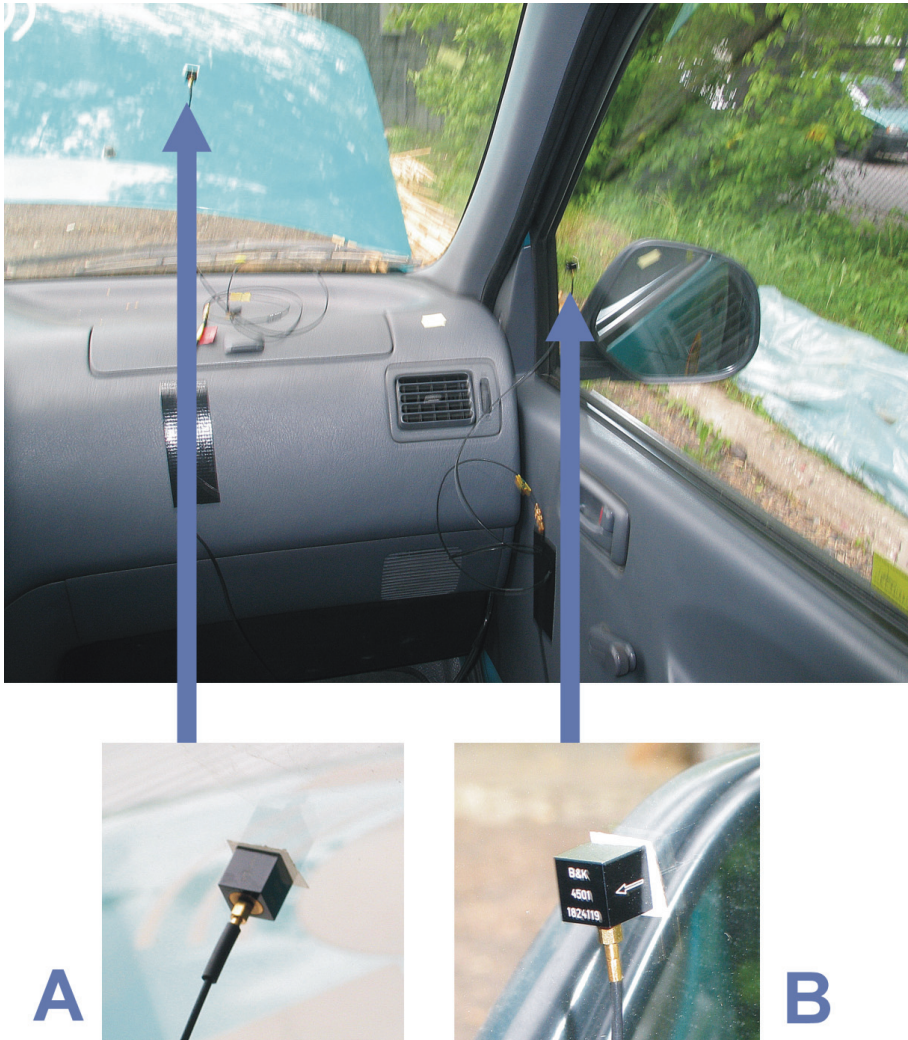
Rys. 8.4. Rozmieszczenie akcelerometrów po wewnętrznej stronie szyb
