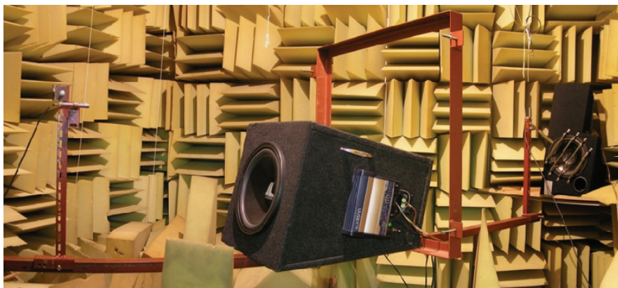
Rys. 5.14. Widok wnętrza komory bezchowej w trakcie badań
