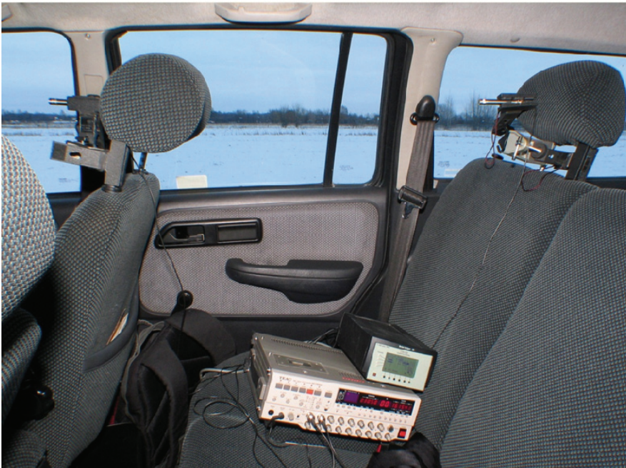
Rys. 2.5. Pomiary poziomów dźwięku nad przednim i tylnym siedzeniem w samochodzie typu kombi
