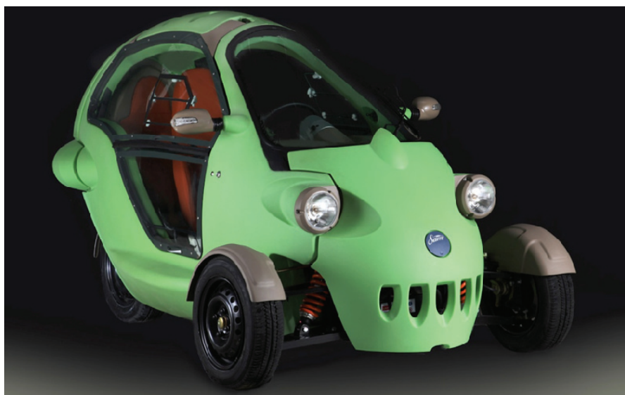
Rys. 2.8. Wykonany z polietylenu dwumiejscowy pojazd elektryczny z silnikiem umieszczonym w wahaczu tylnego koła
