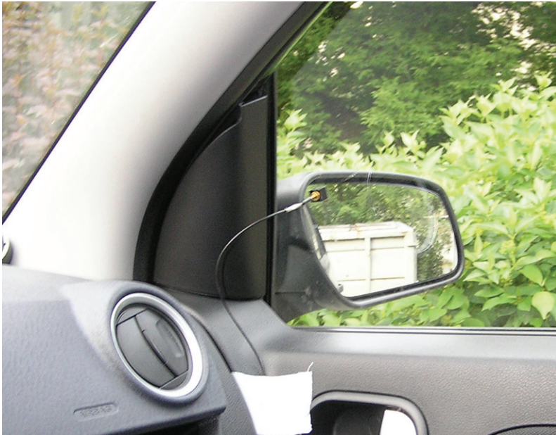
Rys. 9.8. Akcelrometr zamontowany na szybie przy lusterku bocznym samochodu Ford Fusion – źródło sygnału odniesienia dla układu ARH
