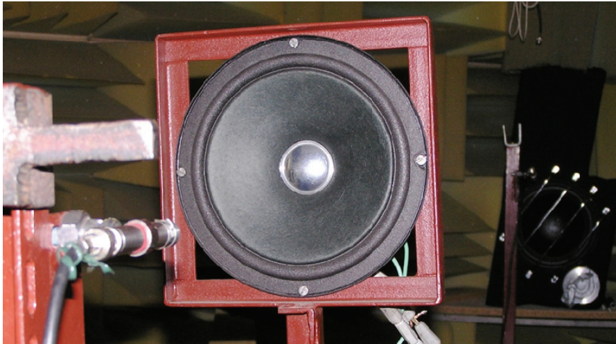
Rys. 8.12. Ustawienie elementów układu ARH w komorze bezechowej
