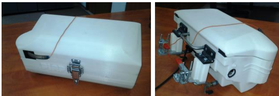
Rys. 1.11. Funkcjonalny prototyp innego typu korpusu nawijarki z materiału ABS-M30 wytworzony z zastosowaniem technologii FDM
