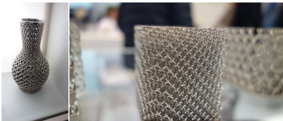
Rys. 7.7. Przykładowe modele wytworzone przy wykorzystaniu prymitywów struktur wewnętrznych
