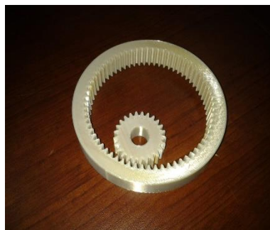
Rys. 1.14. Elementy wytworzone z zastosowaniem technologii FDM mające zastosowanie w urządzeniach produkcji PIAP: a) elementy przekładni maltańskiej wytworzone z materiału ULTEM9085; b) koła zębate wytworzone z materiału ULTEM9085
