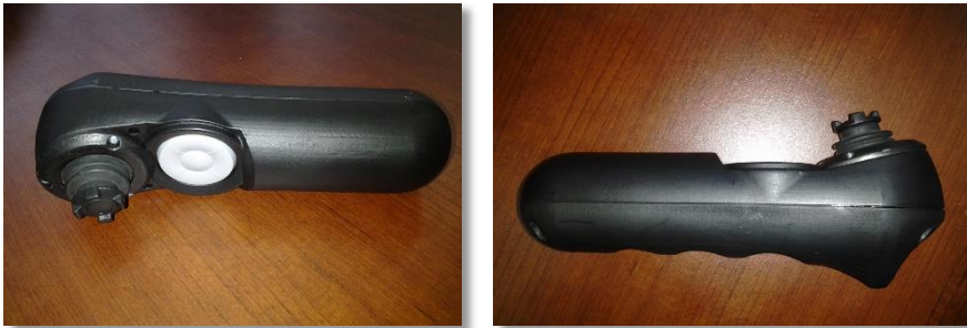
Rys. 1.13. Kontroler robota. Obudowa została wytworzona z zastosowaniem technologii FDM
