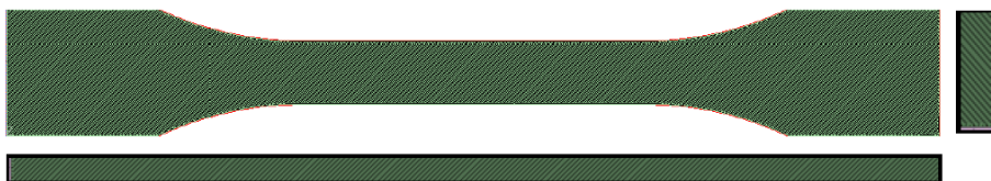
Rys. 4.2. Geometria wypełnienia lita-włóknista
