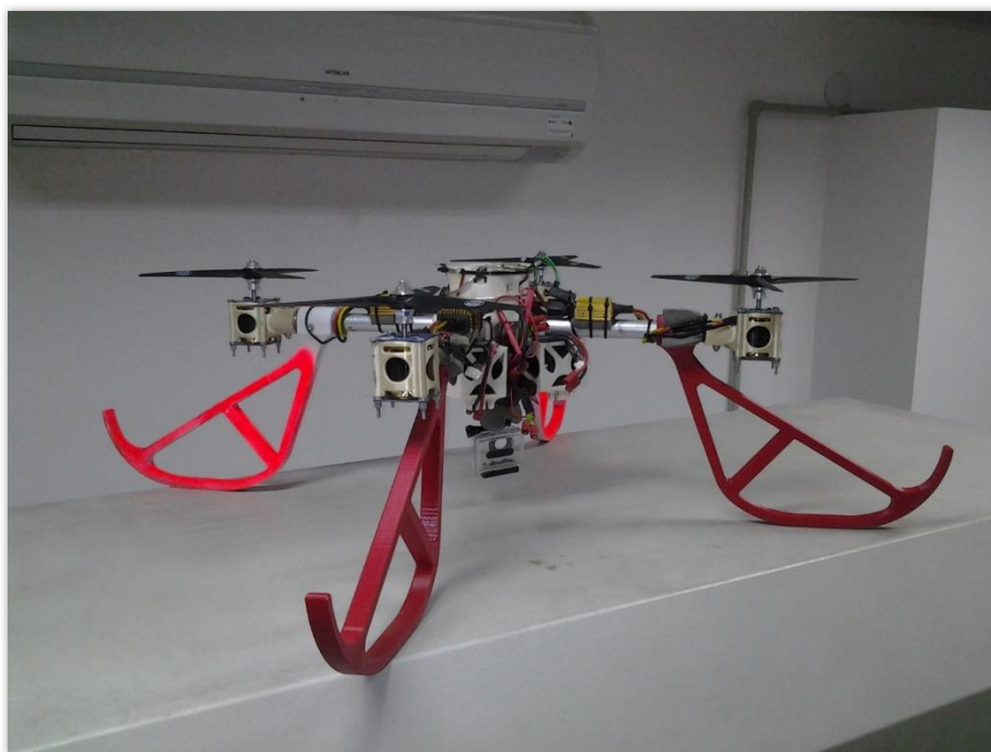
Rys. 1.12. Działający wielowirnikowiec zaprojektowany i wytworzony w Instytucie PIAP, w przeważającej większości z zastosowaniem technologii FDM
