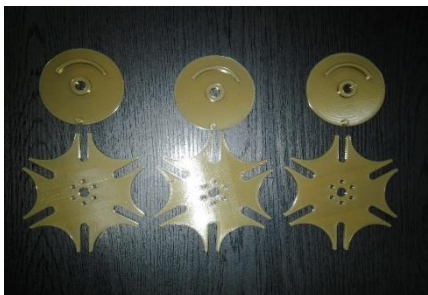
Rys. 1.14. Elementy wytworzone z zastosowaniem technologii FDM mające zastosowanie w urządzeniach produkcji PIAP: a) elementy przekładni maltańskiej wytworzone z materiału ULTEM9085; b) koła zębate wytworzone z materiału ULTEM9085
