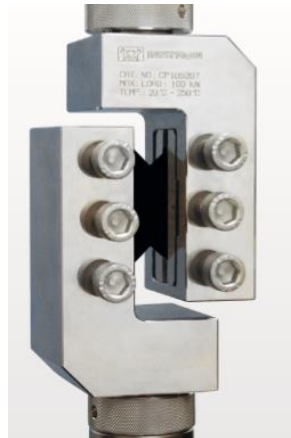
Rys. 4.17. Przykładowy uchwyt przeznaczony do prób czystego ścinania
