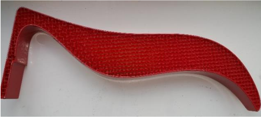
Rys. 1.9. Przekrój przez prototyp po obróbce wykończeniowej (lakierowanie) z kratową geometrią wewnętrzną
