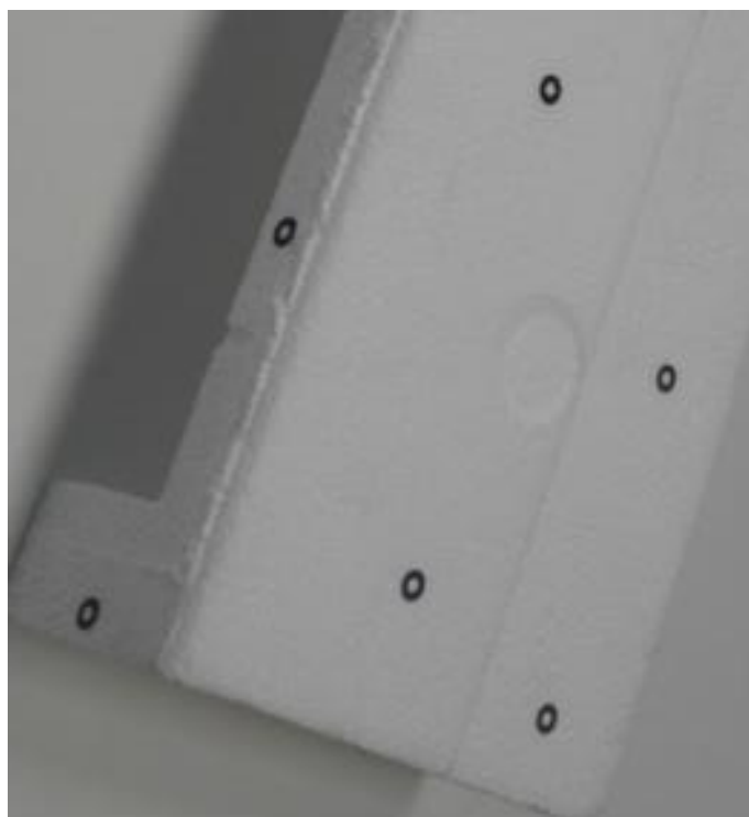
Rys. 4.31. Przykładowy model z naklejonymi markerami ułatwiającymi łączenie geometrii
