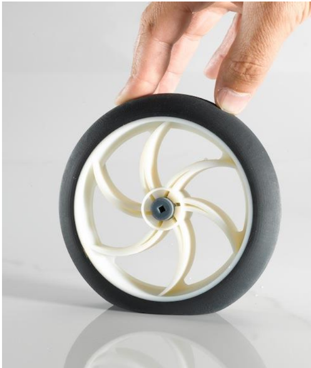
Rys. 7.10. Zdjęcie dostarczone przez korporację Stratasys pokazujące prototyp zabudowany w jednym procesie (bez montażu) w technologii PolyJET Matrix – sztywna felga i gumopodobna opona
