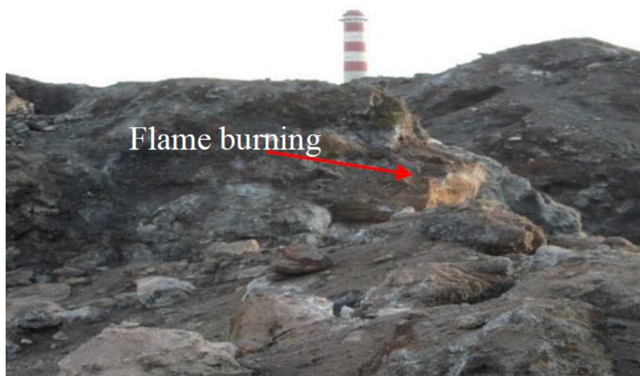
Fig. 3.15. Flame burning on coal dump Orzeł Biały – Brzeziny Śląskie (pic. Damian Cyfka)
