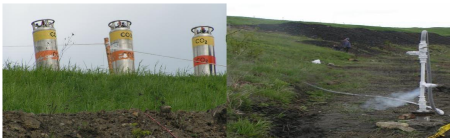
Fig. 4.10. Injection of \text{CO}_2 on Waleska dump of “Bolesław Śmiały” Coal Mine (KWK Bolesław Śmiały) [source: own]
